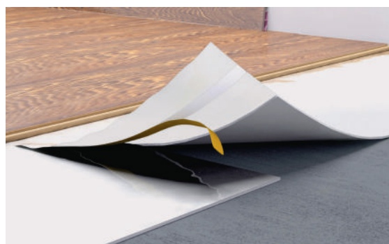
Chevauchement de 6 cm, avec bande auto-collante et recouvrement par bande adhésive résistant à la déchirure.
